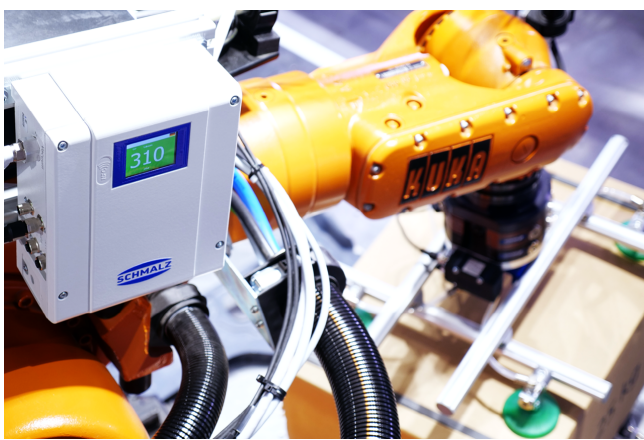
Pompe électrique compacte GCPI lors de la manipulation de cartons
